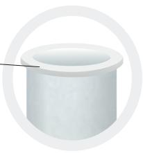
Наличие заглушки является важным конструктивным решением. Фильтр остается целым, не деформированным, чтобы минимизировать риск возникновения трещин при попытке запаять или заплавить конец фильтра другим способом. При производстве фильтра, полипропилен, остывая теряет пластичность и при запаивании конца фильтра в местах сгиба могут образоваться трещины, которые в дальнейшем повлияют на качество очистки молока.
