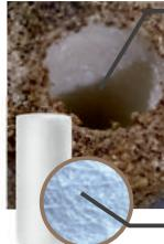
Структура намотки нитей из волокнисто-пористого полипропилена, запатентованная компанией «МИЛКФОР» обеспечивает высокую степень очистки сусла. При этом плотность намотки нитей находящихся ближе к центру выше, чем на периферийных слоях, что обеспечивает более тонкую очистку ближе к центру.
