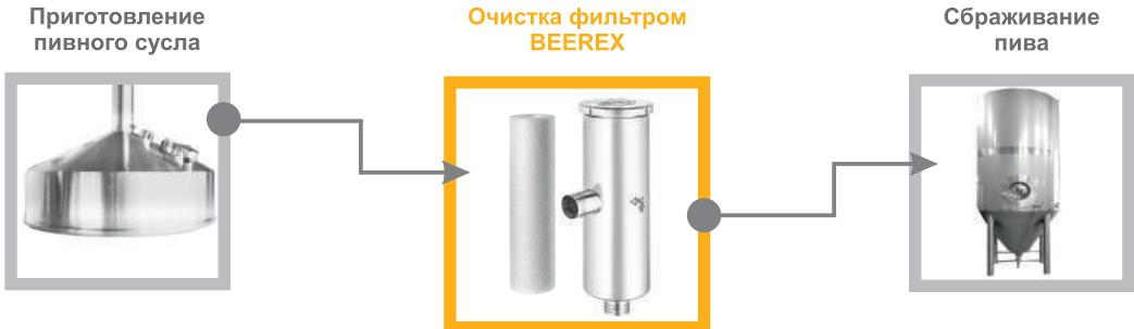
Удаление механических примесей до попадания сусла в ЦКТ позволяет снизить нагрузку на фильтр-пресс с кизельгуровым фильтрующим элементом. Это позволяет увеличить срок его службы.
